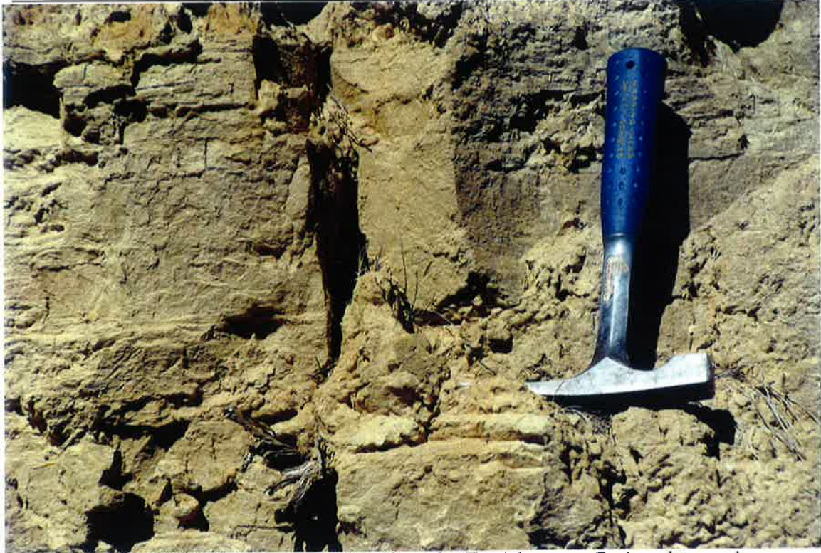
FOTO 9027- Columna estratigráfica de Tordehumos. Facies de arenisca con laminaciones de ripples (Sr) en la Facies de Tierra de Campos.
